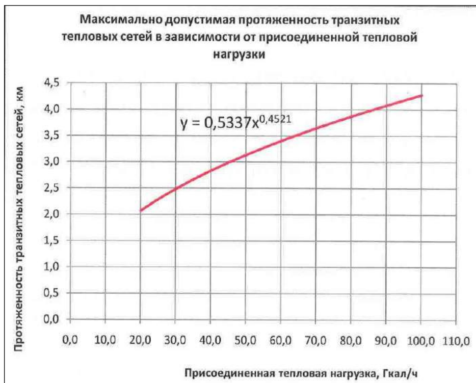
Рис. 3 Максимально допустимая протяженность тепловых сетей в зависимости от присоединенной тепловой нагрузки от 20 Гкал/ч
